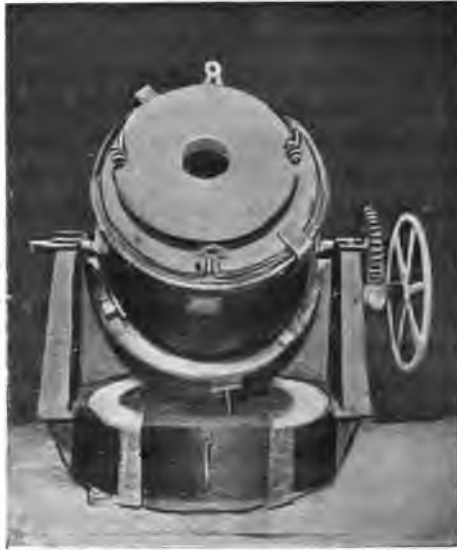
Fig. 86 — Four creuset à charbon.
